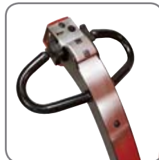
Möjligt att manövrera med styrhandtaget helt lodrätt. Central placering av alla betjäning-funktioner.
