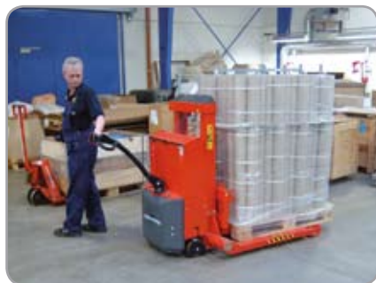
Optimal säkerhet bl.a. med slagfast, transparent skyddsskiva och reducerad hastighet i upplyft läge.
