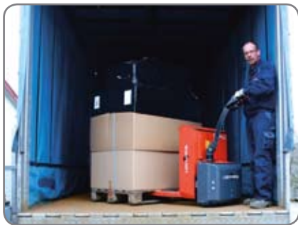
Panther Maxi (kapacitet 1800 kg) rekommenderas för tyngre palltransport, t.ex. ombord på lastbilar.
