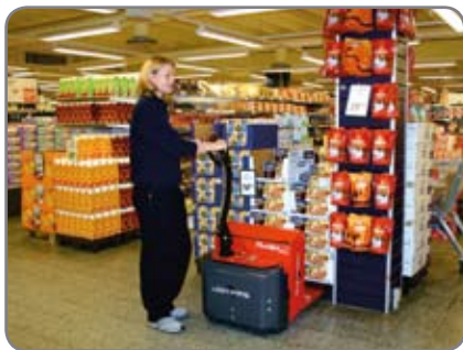
Panther Mini (kapacitet 1400 kg) rekommenderas för lättare palltransport, t.ex. i varuhus och på lager.
