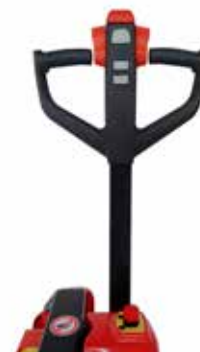
Ergonomisch handle met zachte grip, keert zacht terug naar verticale positie. Werkt met handle verticaal.
