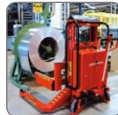
Logiflex med fasta snedställda gafflar för hantering av rullar med stor diameter.
