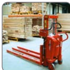
Logiflex med tre extra långa gafflar för hantering av långt tungt gods.
