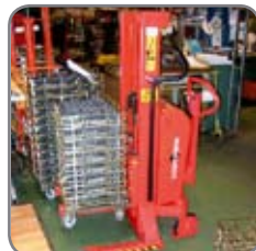
Logiflex i en speciellt kort version för hantering av trädbackar.
