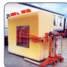
Bredspårig Logiflex med speciella griparmar för skumplastbalar.
