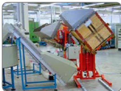
Logiflex med sidotiltgafflar för lyft och tömning av ämnen i en processanläggning.
