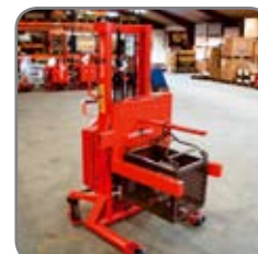
Logiflex med sidotiltgafflar och pikbom för lyft och tömning av trädorgar.
