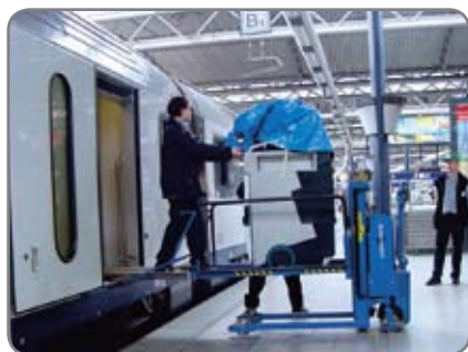
Logiflex med fällbart lastbord för lyft av serveringsvagnar i och ur tåg.
