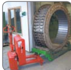
Panther Maxi med dragkula för förflyttning av vagnar.
