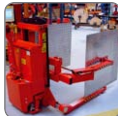
Bredspårig Logiflex med speciella griparmar för lättare material.
