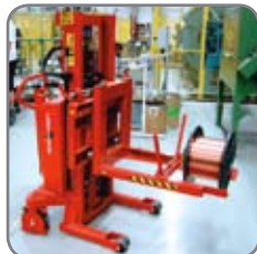
Logiflex med sidoförskjutbar konsoll och teleskoperande gafflar för hantering av spolar.
