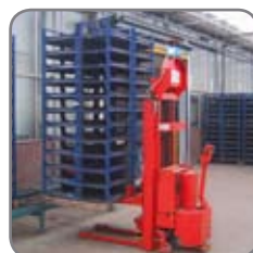
En automatiskt styrd Logiflex typ SELF. Här för automatisk leverans av tompallar till en rullbana.
