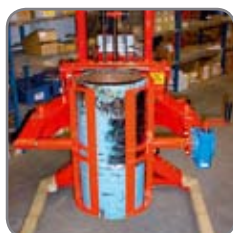
Logiflex med specialanpassad fatvändare för fat som avviker från standard.
