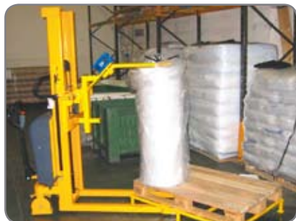
Rullvärdare. Ett bra alternativ när rullar skall lyftas och vändas.
