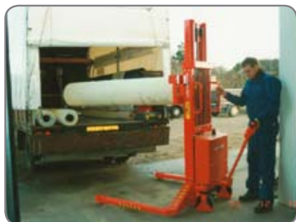
Bredspårig Logiflex vid hantering av rullar från lager till lastbil.
