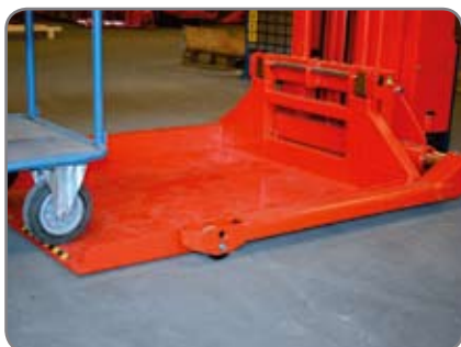
Plattformens framkant är avfasad för lättare påkörning.
