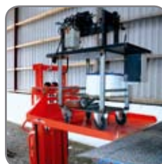
Logiflex med plattform lyfter här en vagn från en ramp.
