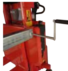
Verstelbare boxhouders: De breedte is aan te passen door een handle, zodat de breedte past bij de boxbreedte (tussen 800 mm en 1200 mm).
